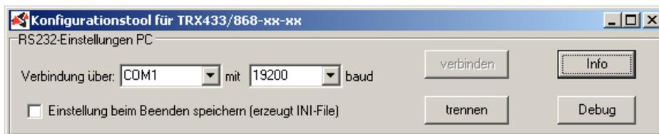
Durch klicken auf die Schaltfläche *verbinden* wird die Verbindung zum TRXnnn-10 hergestellt und die LED auf dem TRXnnn-10 leuchtet. Mit der Schaltfläche *trennen* kann die Verbindung wieder getrennt und die Speisung des Moduls abgeschaltet werden.
