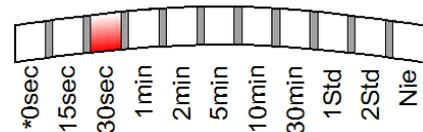
Wird die Aktivierungsdauer auf 0s eingestellt, muss jede Aktion mit der Funkfernsteuerung mit einem Doppelklick ausgeführt werden. Wird die Taste wieder losgelassen, wird der Handsender unmittelbar wieder verriegelt. (\* 3s bei Handsender mit aktiver Schliess- und/oder Anhängerfunktion)
