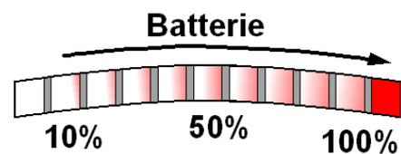
Wenn die Batteriespannung unter 2.3V sinkt, blitzt die LED 10 bei aktiviertem Handsender einmal pro Sekunde auf. Dieser Warnhinweis zeigt an, dass die Restkapazität der Batterie weniger als 20% beträgt und ein Batteriewechsel unmittelbar bevorsteht.
